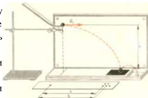
$$V_{\text{ср}} = L_{\text{ср}}\sqrt{\frac{g}{2h}}$$
